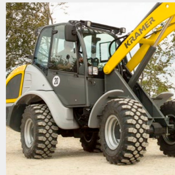
Hundeganglenkung für präzise Positionierung
