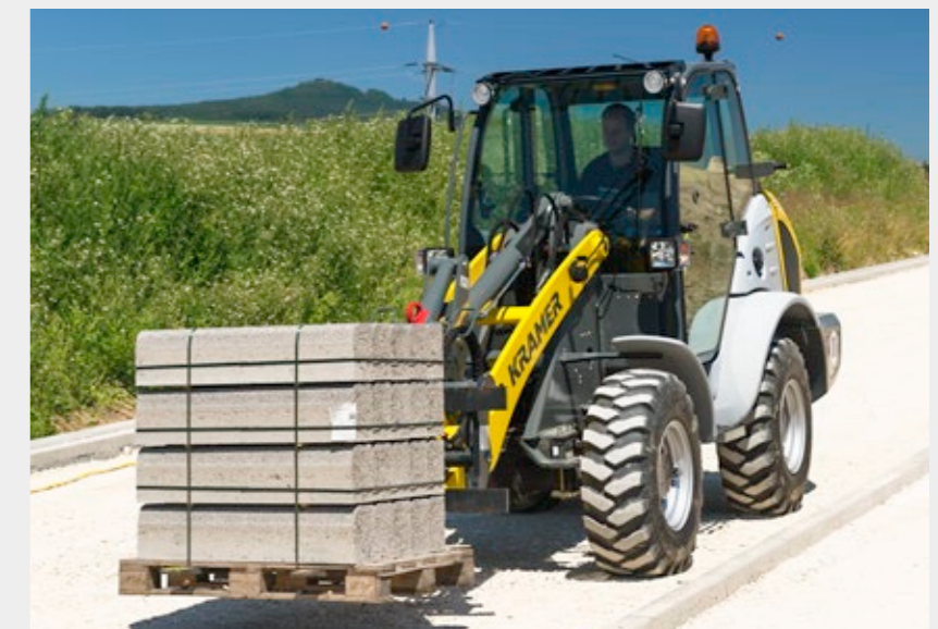
Vorderachslenkung für erhöhte Sicherheit bei schnellen Transportfahrten
