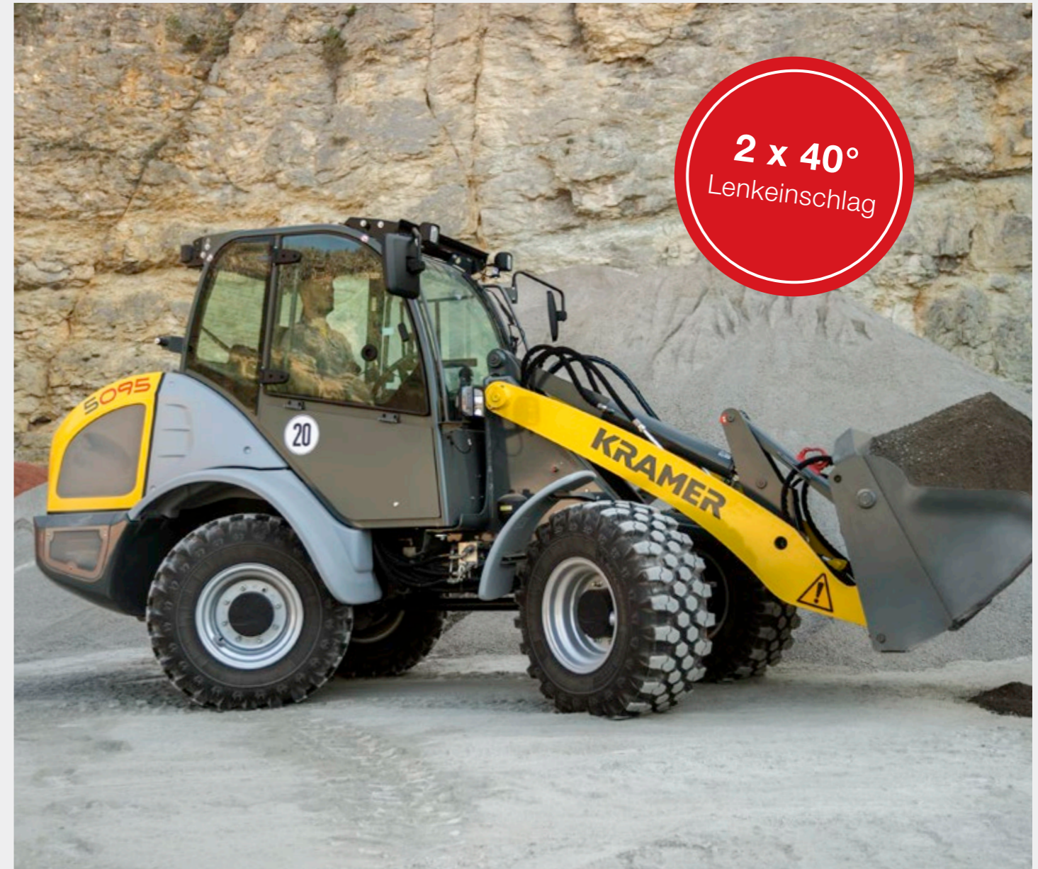
Allradlenkung besonders wendig bei eingeschränkten Platzverhältnissen
